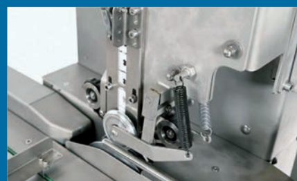
Przystosowane do zamykania woreczków przy użyciu klipsa, opaski zaciskowej lub taśmy
