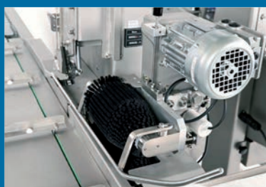
Szczotkowy napinacz woreczków przed zamknięciem
