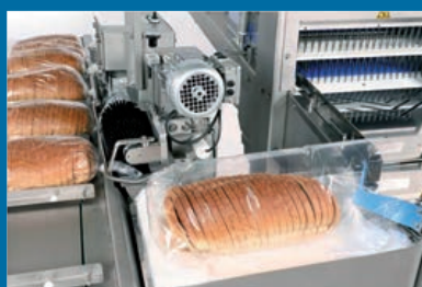
Rozdmuchiacz woreczków zintegrowany z krajalnicą ułatwia pakowanie pokrojonego chleba
