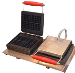
Gofrownica podwójna na 8 gofrów EBosh wymiar pojedynczego gofra: 100x70x23 mm płyta grzewcza z żeliwa, obudowa stal nierdz. regulacja temperatury: 0 - 300°C zasilanie: 220V, moc: 3,2kW Cena netto: 3040,00zł/szt
